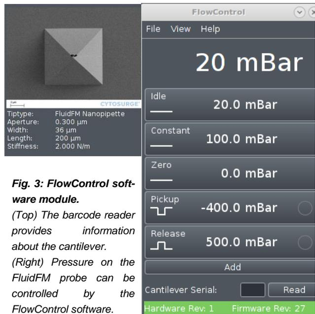
**Fig. 3: FlowControl software module.**
